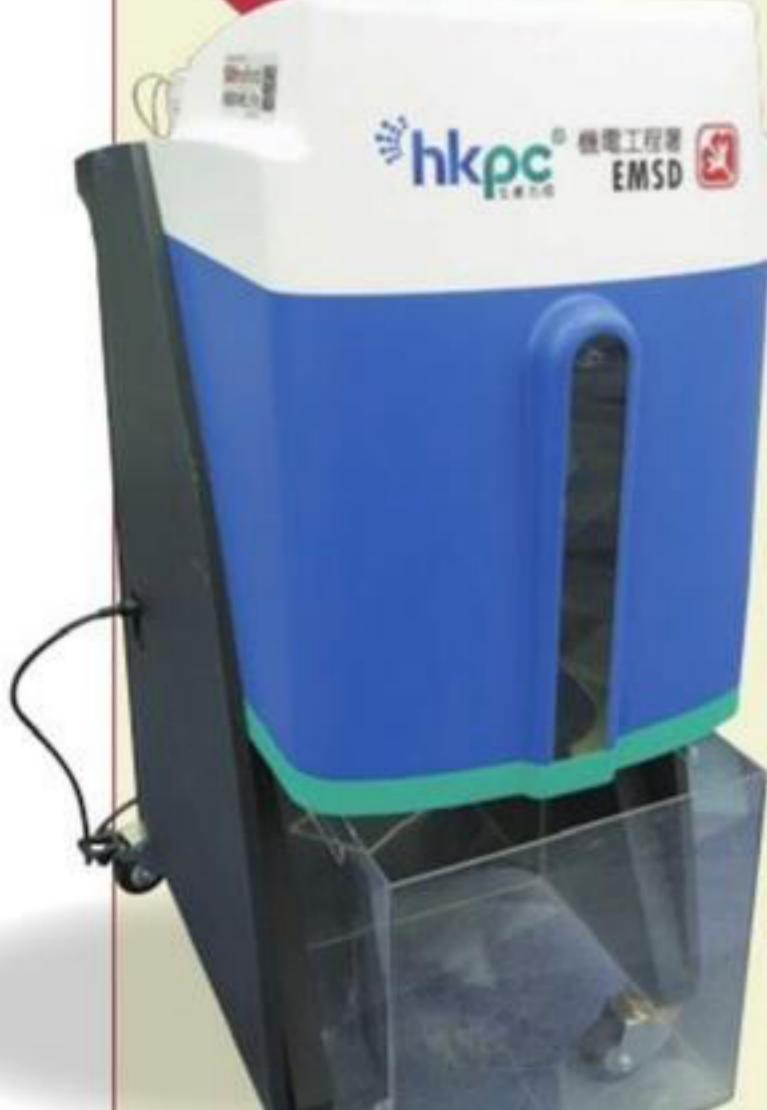
該自動清洗系統可在封閉的空間內清洗馬桶，包括清潔、消毒，以至去除殘留污垢。機械人具備影像檢查、分析演算法，控制水和洗滌劑噴霧器的壓力等，並能自動對準位置走到馬桶上清潔。
